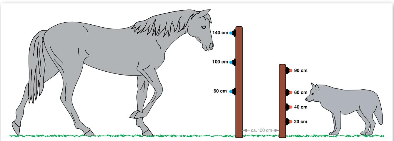
Abbildung 18: Zwei getrennte Zäune (beide Zäune müssen mit demselben Gerät betrieben werden) (© G. Herkert)
